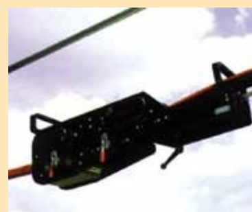
• Ferramenta de aplicação manual de MVLC
